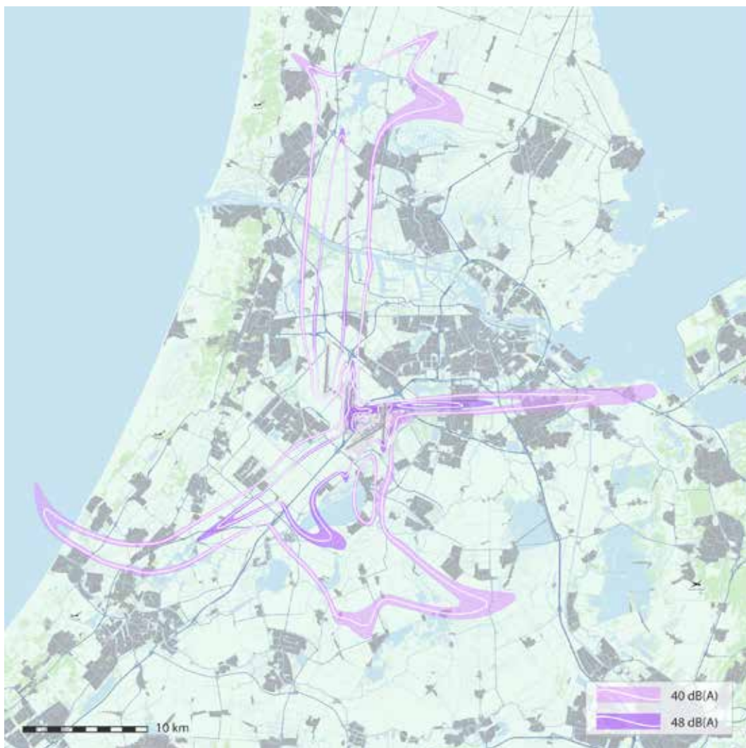
Figuur 5.2 Verwachte jaargemiddelde geluidbelasting over de nachtperiode L_{night} voor het gebruiksjaar 2015, met spreiding als gevolg van weersvariaties
