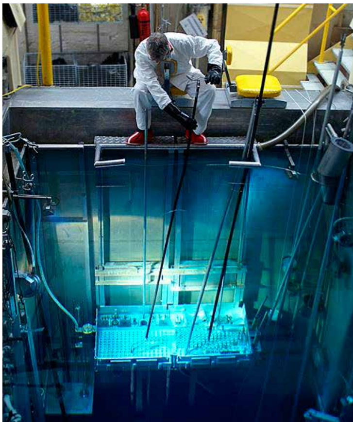
In de Hoge Flux Reactor in Petten: de bestraalde capsules met Lutetium worden klaar gemaakt voor verwerking in het laboratorium.
