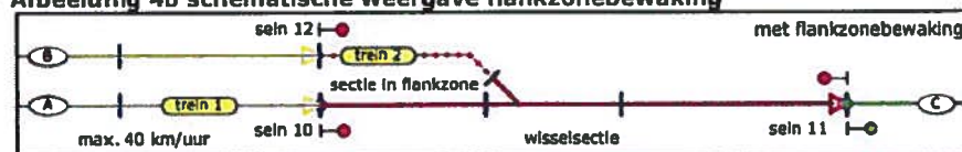
Afbeelding 4b schematische weergave flankzonebewaking
