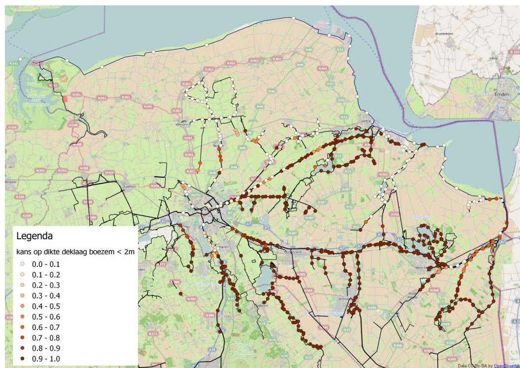
Figuur F.1 Kans op deklaagdikte bij regionale keringen minder dan twee meter (criterium voor hydraulische kortsluiting)
