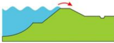
Figuur 4.1 Overslag of overloop bij onvoldoende kruinhoogte
