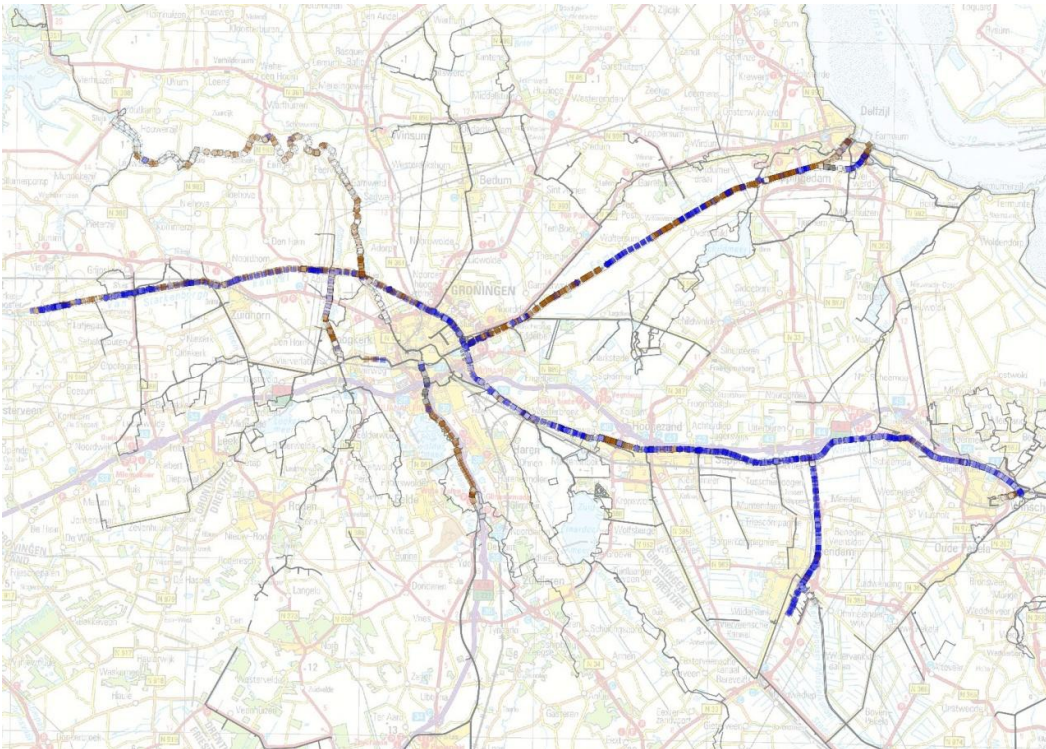
Figuur F.2 Bekende locaties voor beschoeiing (blauw is stalen damwand, bruin is houten beschoeiing, grijs is betonnen damwand, wit is overige) – Een beschoeiing tot in de deklaag is ook een criterium voor hydraulische kortsluiting
