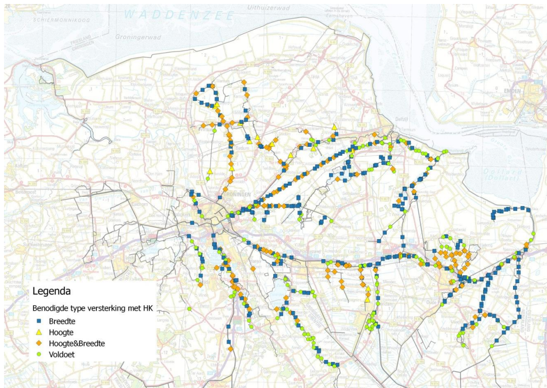
Figuur K.3 Overzicht van te verbeteren strekkingen voor kruinhoogte en dijkbasisbreedte (geel=hoogtetekort, blauw=breedtetekort, oranje=beide, op basis van het meest ongunstige ondergrondscenario)
