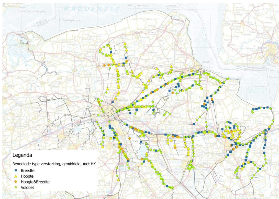
Figuur 5.2: Overzicht van de dominante maatregel per rekenpunt. Dit resulteert in de uiteindelijk te verbeteren strekkingen van regionale keringen voor kruinhoogte en dijkbasisbreedte op basis van een gewogen gemiddelde over ondergrondscenario's (geel=hoogte tekort, blauw=breedte tekort, oranje=beide)
