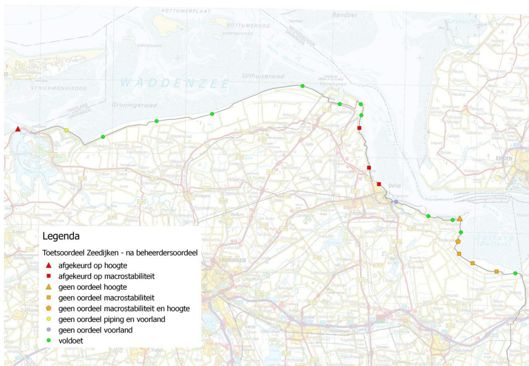
Figuur K.1 Primaire keringen, met ligging van de macrostabiliteitsvakken, en de bijbehorende conclusies uit de derde toetsronde
