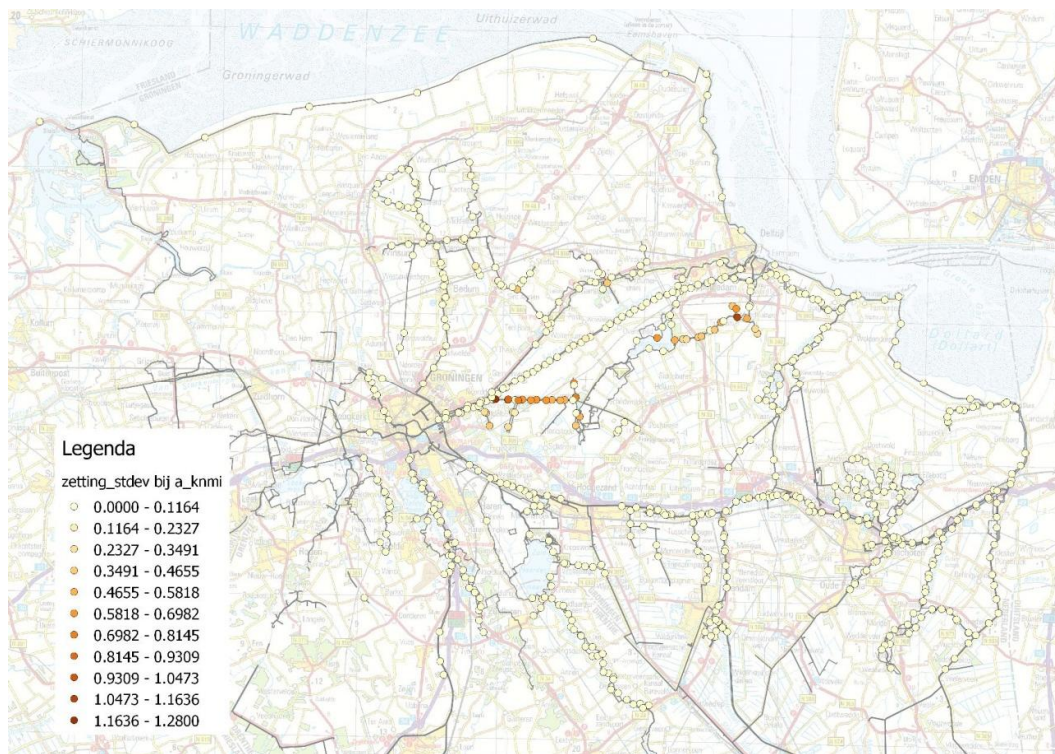
Figuur L.4 De standaardafwijking over alle ondergrondscenario's volgens de kwetsbaarheidscurve, bij 1 waarde van de door KNMI voorspelde piekversnelling ( m/s^2 , 1:475 per jaar). De standaardafwijking bij de zeedijken is nul, omdat daar maar met een ondergrondscenario is gerekend
