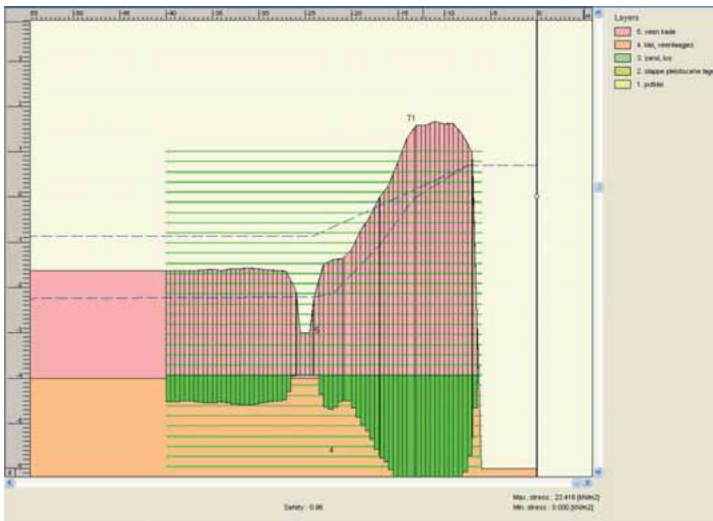
Figuur 4.15 Veen kade: horizontaal evenwicht bij hydraulische kortsluiting; geen droge omstandigheden
