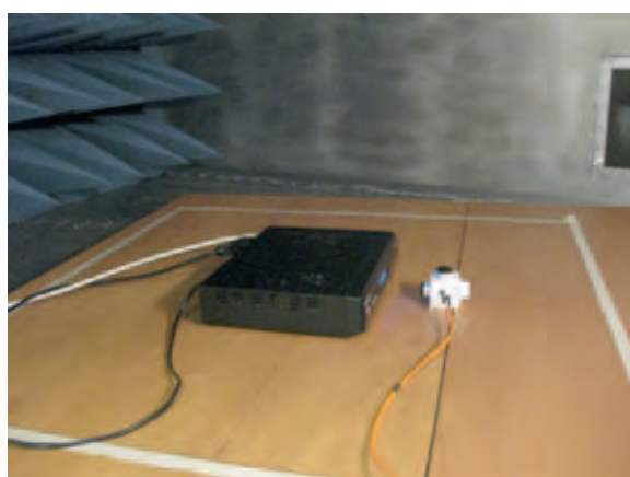
Figuur 4 en 5. Sensor bij settop box en televisietoestel in GTEM
