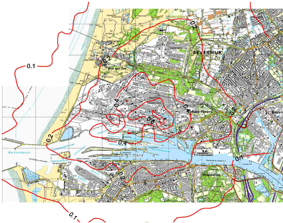
Figuur B3. 8 Berekende bijdrage door de emissies bij Corus in 2004 aan de jaargemiddelde concentratie Benzo(a)pyreen in \text{ng m}^{-3} (Provincie Noord-Holland, 2007)
