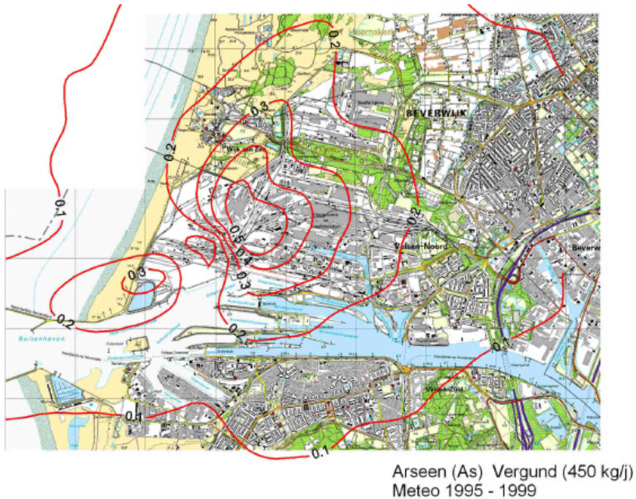
Figuur B3. 5 Berekende bijdrage door maximaal vergunde emissies bij Corus aan de jaargemiddelde concentratie arseen in \text{ng m}^{-3} (Provincie Noord-Holland, 2008)
