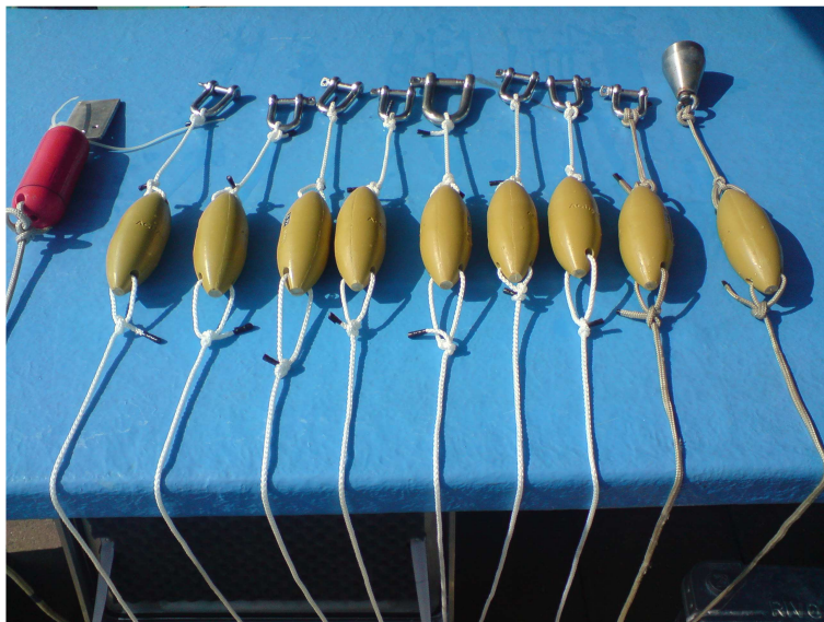
Figuur 21. Optuiging AquaMark 100 pingers kort voor de kalibratie op 10 april 2008 met aan de linkerkzijde de referentiebron Ducane Netmark 1000.
