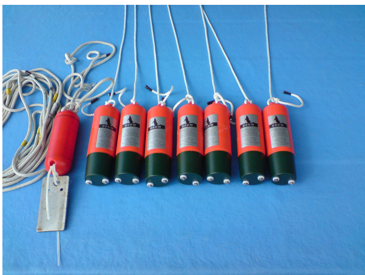
Figuur 22. Optuiging DDD-02 pingers kort voor de kalibratie op 10 april 2008 met aan de linkerkzijde de referentiebron Ducane Netmark 1000.
