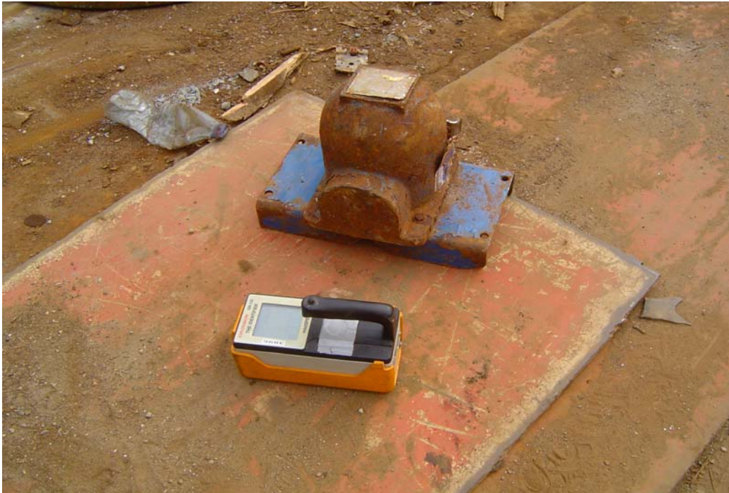
Foto 1: uit lading schroot verwijderde cesium-137 bron
