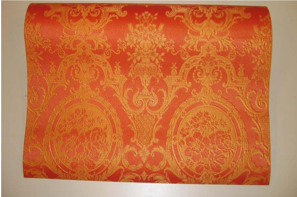
Foto 11: behang met toegevoegde radioactieve stoffen
