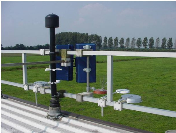
Figuur 2.6 Foto van de meetlocatie in Zegveld. De twee DELTA-systemen (blauwe kastjes) zijn vastgemaakt aan de reling vlak naast de aanzuigpijp van de AMOR.
